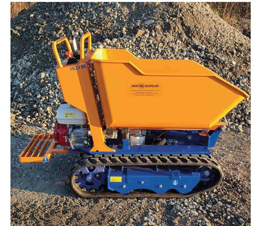
Der Kettendumper Typ 06 ist eine äußerst vielseitige Maschine, die dank ihrer Kompaktheit und Wendigkeit effizientes Arbeiten auf engstem Raum ermöglicht.
